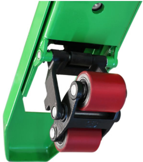
Geschlossene Unterseite der Gabeln für einen höheren Schmutzschutz.
